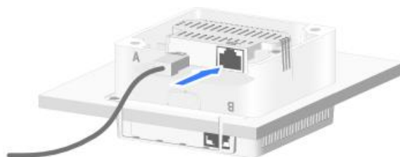
Gambar 1-14 Menghubungkan Kabel Ethernet
