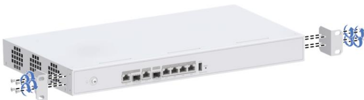
Gambar 1-3 Memasang Braket Pemasangan
