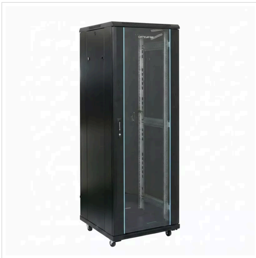
Rack 19" 32U 600x800, montare pe podea, ușă din sticlă, panouri laterale detașabile și securizate, DATEUP MS2.6832.9001
